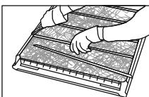
سپس با توجه به شکل روبرو به ترتیب نگهدارنده ها را به طرف داخل فشار دهید و آزاد کنید تا از بدنه مشبك جدا شود.
