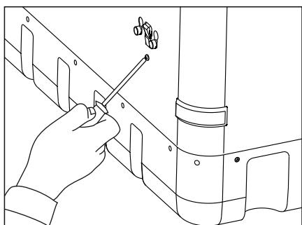
ج: با توجه به شکل زیر قفل نگهدارنده کلاهک پمپ آب را از بیرون کولر به طرف داخل فشار دهید. سپس زبانه های اتصال کلاهک پمپ را تا انتهای شکاف سوراخ آنها بالا آورده و به طرف داخل فشار دهید تا پمپ آزاد شود.
