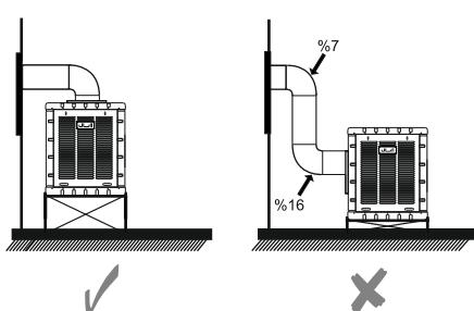
هنگام نصب کولر خروجی از بالا باید دقت شود که جهت کاتال کولر با جهت پیکان روی کولر یکسان باشد تا کمترین افت بوجود آید. در صورت نصب اشتباه (خلاف جهت فلش) افت هواهدهی نزدیک به اندازه ۱۰-۱۵٪ خواهد بود.
