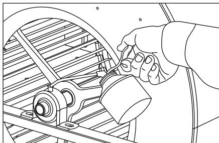
**هشدار:** برای روغنکاری یاتاقان ها باید از روغن مخصوص (توربین ۱۰۰) استفاده شود.
