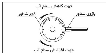
**هشدار: هنگام تنظیم ارتفاع آب باید با یک دست بازوی شناور را ثابت نگهداشته و با دست دیگر گوی شناور را تنظیم کنید.**
