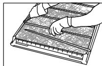
سپس با توجه به شکل روبرو به ترتیب نگهدارنده ها را به طرف داخل فشار دهید و آزاد کنید تا از بدن مشبك جدا شود.
